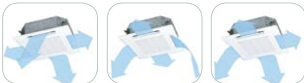
Die Optimierung des Designs der Luftleitlamellen gewährt eine einheitliche und weitreichende Luftverteilung, im gesamten Raum. Außerdem hat die Vergrößerung der Ausblasöffnungen, die Last des Ventilatormotors bemerkenswert vermindert, dadurch wurde die Energieeffizienz erhöht.
