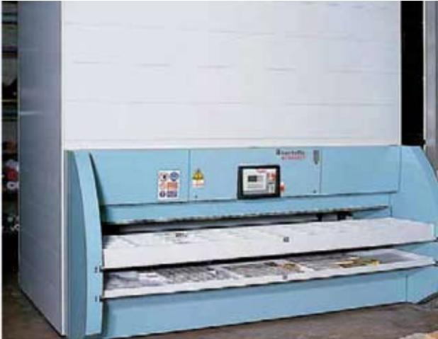
Die Verwaltung der Ersatzteile erfolgt durch 3 automatische vertikale Lagerungssysteme, die im zentralen Logistikbereich im Hauptsitz Bologna stehen. Es handelt sich um 3 Türme, die jeweils 10 m hoch sind, in denen Metallbehälter untergebracht sind, und durch ein Hebewerk bewegt werden. Das System ist in der Lage, rund 5.000 Codes zu verwalten aufgeteilt auf insgesamt 50.000 Teile etwa, immer verfügbar im Lager.
