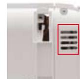
Sensor für die Innentemperatur und die Feuchtigkeit im Raum
