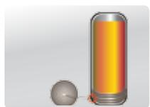
Weitere Rohrwicklung am Boden des Tanks "Nesteffekt" (höheres Brauchwarmwasser-Nutzvolumen)
