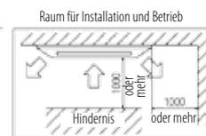
Wenn mehr als ein Gerät installiert wird, muss ein Abstand von 5 m oder mehr zwischen einem Gerät und dem nächsten eingehalten werden.
