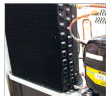
Luftgek., rohrloser Verflüssiger aus schutzlackiertem Stahl
